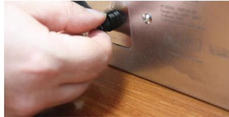
2. Entfernen Sie die durchgebrannte Sicherung und ersetzen Sie sie durch eine neue. Drücken und drehen Sie sie im Uhrzeigersinn, um diese zu installieren.
